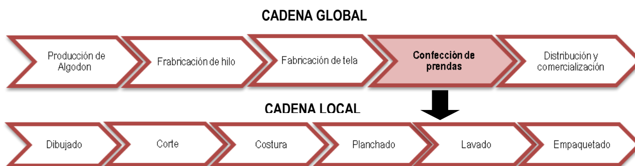
Figura 12: Cadena Global y Local de la Industria Manufacturera Textil
