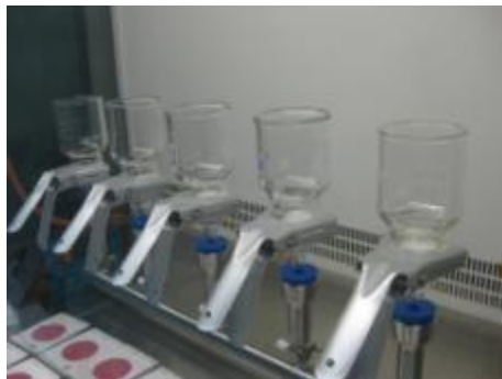
Armado de aparato de filtración al vacío y preparación de membrana.
