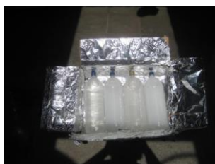
Figura 9. Concentrador solar de paredes planas con botellas plásticas PET colocadas al sol. Fotos López, G.
