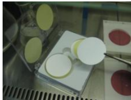
Armado de aparato de filtración al vacío y preparación de membrana.
