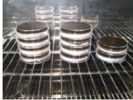
Incubación de placas petri con agar EMB por 24 horas a 37°C. Fotos López, G.
