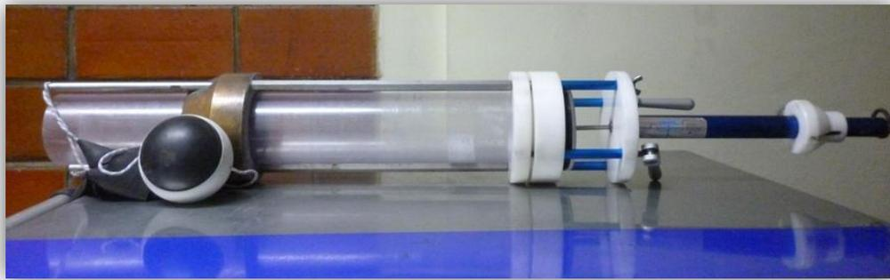
**Figura 4.** Nucleador de tipo Uwitec utilizado para la campaña de muestreo de sedimentos.
