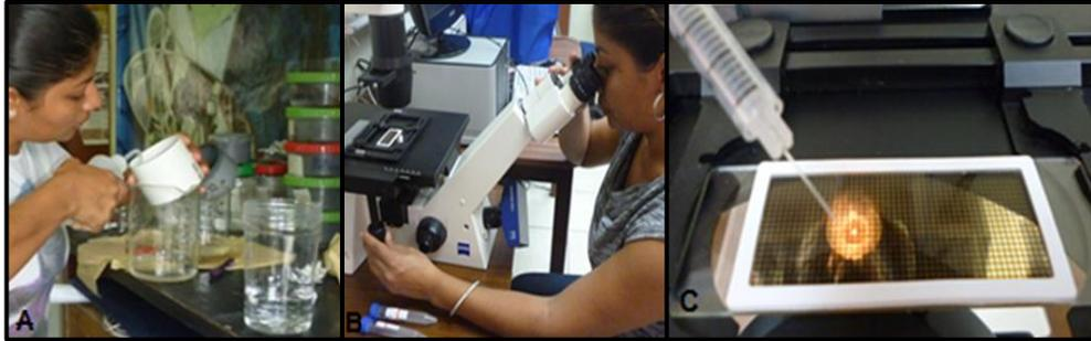
**Figura 6.** A) Tamizado de muestras de sedimento, B) observación de muestra al microscopio invertido, C) Búsqueda y conteo de quiste de dinoflagelados.
