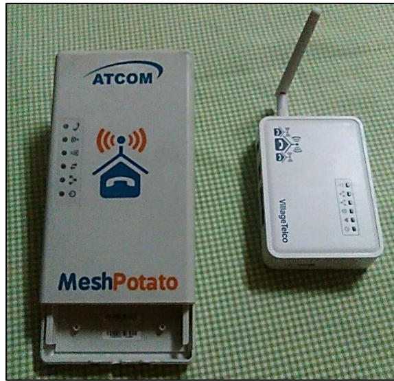
Figura. 2.4 Comparación física, MP01 (derecha) y MP02 Phone (izquierda).
