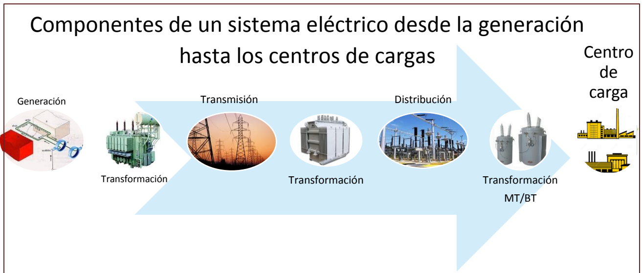
Figura 1. 8 Elementos de un Sistema de Potencia
