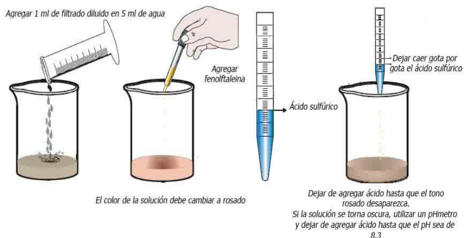
Figura 7.8. Procedimiento para la obtención de la alcalinidad de filtrado Pf.
