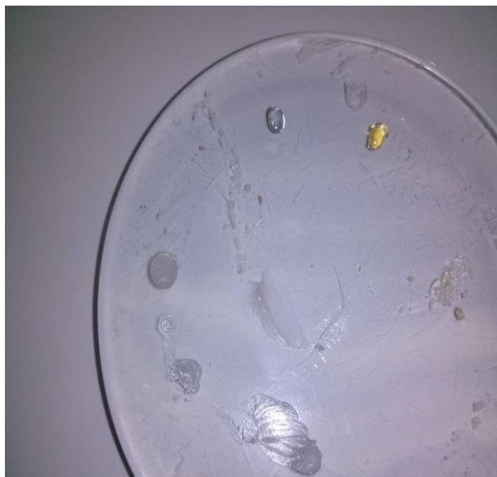
Figura N°19 Pruebas de control de calidad físico color, olor, homogeneidad, untuosidad, transparencia.
