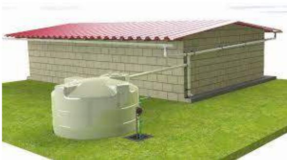
Imagen 20 Tanque Rotoplas instalado con captación de ALL
