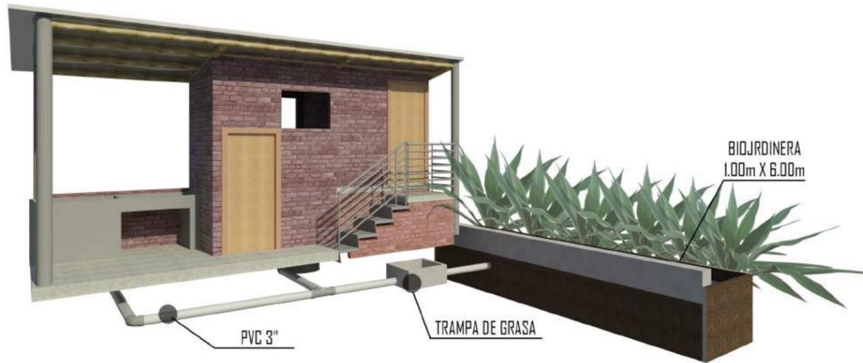
**ESQUEMA DE FUNCIONAMIENTO DE TRATAMIENTO DE AGUAS GRISAS SIN ESCALA**
