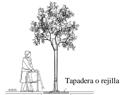
Imagen 16: Esquema de tapadera de protección en hueco de árbol.
