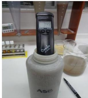
Figura 4. a) Toma de PH y Temperatura de la entrada del tanque de lodos. Fotos. Pérez, L.
