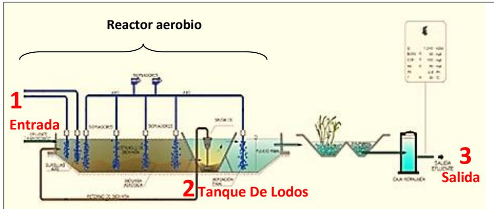
Figura 3. Esquema de la depuradora de lodos activados con los tres puntos de muestreo.
