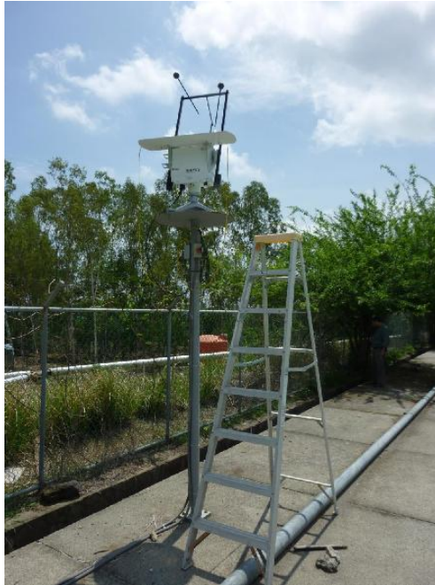
Figura 2.3. Fotografía del piranómetro utilizado en la Estación Solar TR11 montada en el caserío El Tronador, Berlín, Usulután.
