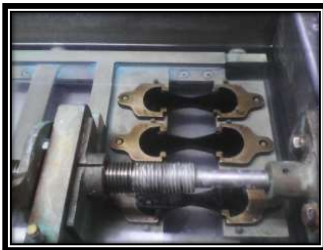
Imagen 2.13 Ensayo de ductilidad.
