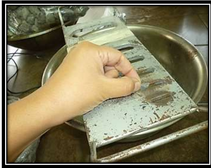
Imagen 2.4 Índice de lajas o Índice de Flakiness
