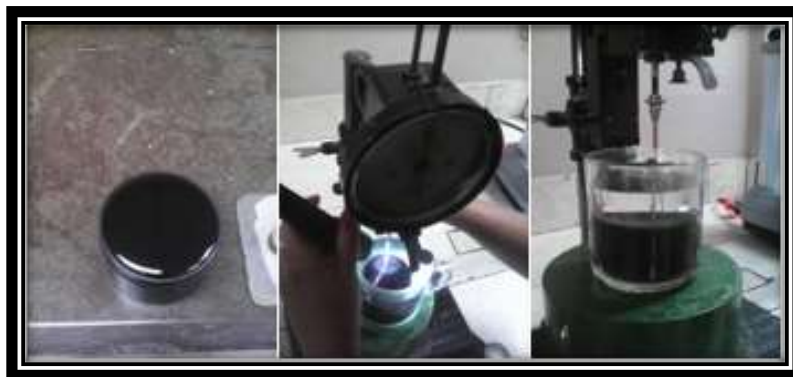
Imagen 2.12 Ensayo de penetración.
