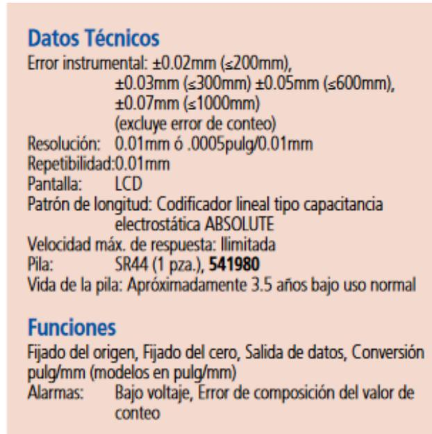
Fig. 3.1. Ficha técnica del calibrador electrónico Mitutoyo para la serie 500 Digimatic Absolute
