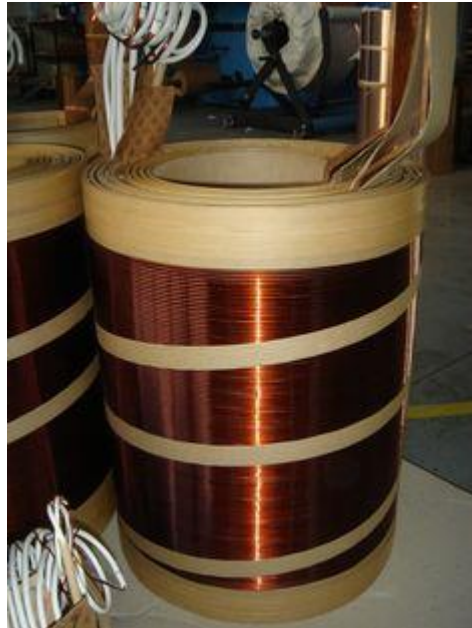
Figura 6 Transformador con papel Kraft como aislamiento sólido 8
