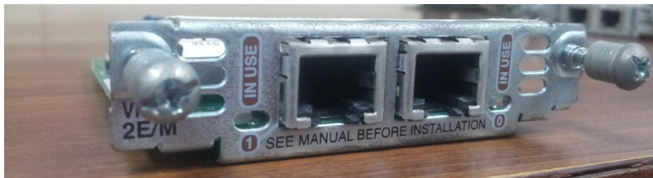
Figura 1.15 Vista frontal de las tarjetas de voz VIC-2E/M.
