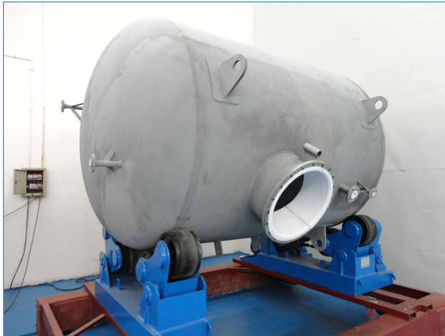
Figura 6.4 Tanque de almacenamiento de Ácido Sulfúrico al 98% p/p.
