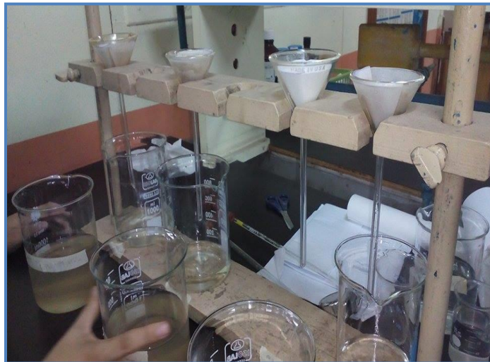
Figura 4.2 Separación física del sobrenadante por medio de filtración.
