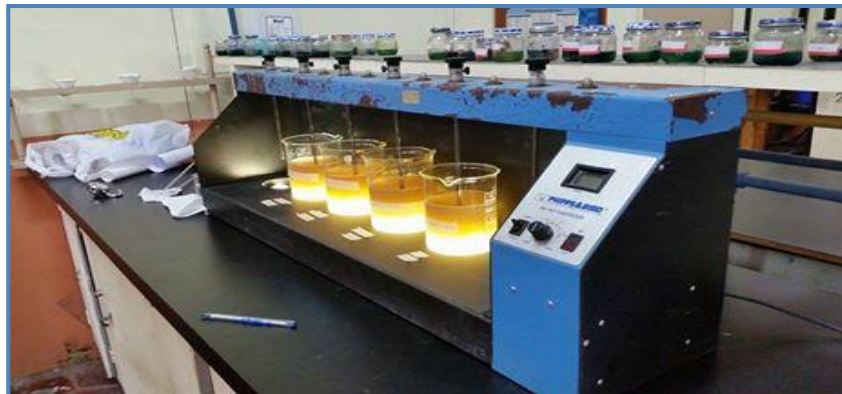
Figura 4.1 Montaje del Equipo de Prueba de Jarras (Jar Test) para la recuperación de aluminio.
