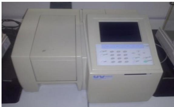
Figura N° 33. Espectrofotómetro. Equipo utilizado para la estandarización del *Lactobacillus casei shirota*.
