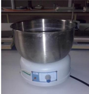
Figura N° 31. Baño maría eléctrico. Equipo utilizado para la pasteurización.
