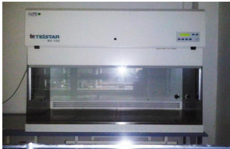
Figura N° 32. Cámara de flujo laminar. Equipo utilizado para la inoculación del *Lactobacillus casei shirota*.
