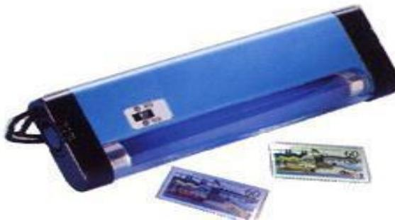
Figura N° 30. Lámpara de luz UV. Equipo utilizado para la determinación de la presencia de fluorescencia en caldo LMX.
