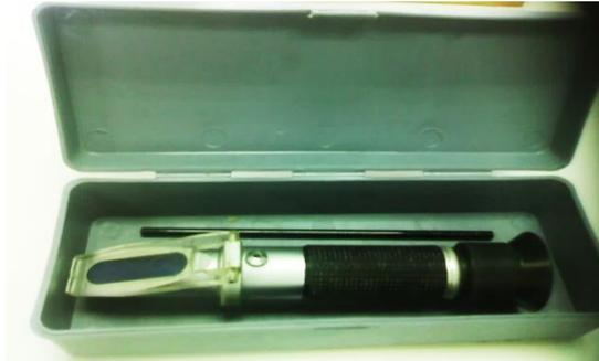
Figura N° 29. Refractómetro. Equipo utilizado para la determinación de grados Brix (sólidos solubles).
