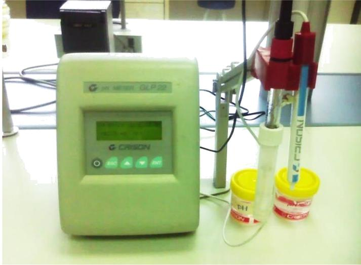
Figura N° 28. pH-metro. Equipo utilizado para la determinación de pH
