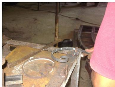
Después de tener cada una de las piezas y adornos cortados, se procede a ensamblar la puerta la cual se coloca en la mesa de armar, donde se verifica que tenga las medidas correctas según el tamaño solicitado.
