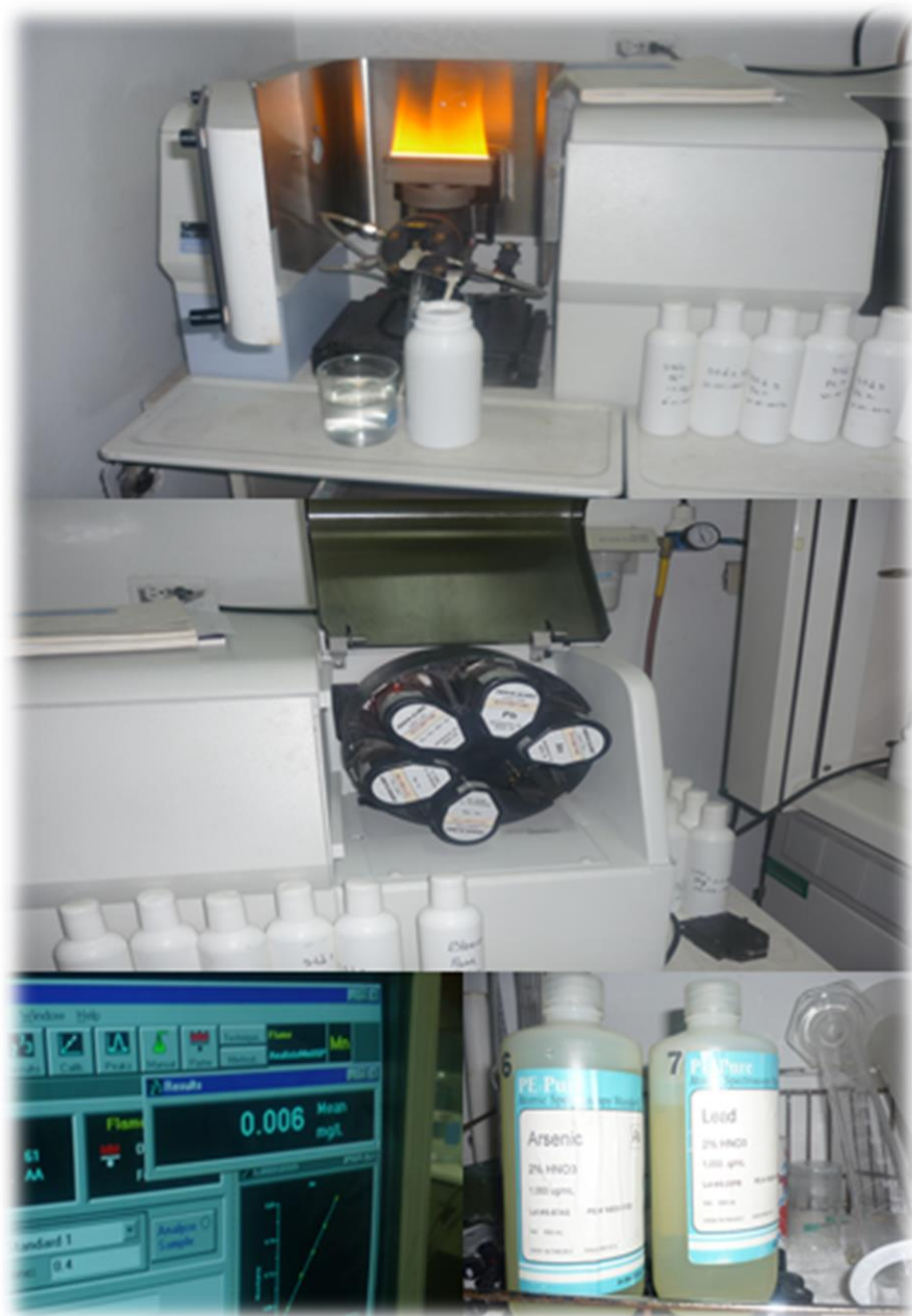
Figura N°20. Determinación de hierro, manganeso, arsénico y plomo por Espectrofotometría de Absorción Atómica
