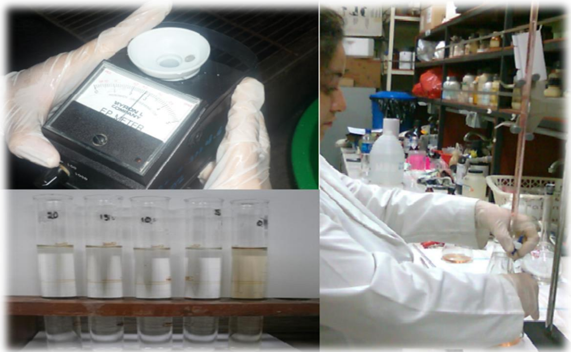
Figura N°19. Determinación de sólidos disueltos totales, color y dureza.
