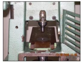
4.2.8. Colocar la Tolva zapata por la parte de atrás de la tableteadora, deslizándola sobre la platina, de manera que coincidan las piezas rodantes de esta, con los ejes de deslizamiento, ubicados a los lados del punzón superior.
