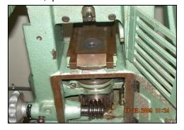
**4.2.6.** Sujetar la platina, colocando los pernos (3), con su respectiva arandela que se encuentran en la parte inferior de la base. Enroscarlos con una llave adecuada, hasta que queden fijos.
