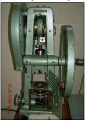
**4.2.2.** Colocar el punzón inferior haciendo coincidir el orificio de la base con la entrada del tornillo sujetador de la base de la matriz, colocar el tornillo sujetador por medio de la llave adecuada para esto, hasta que quede firme.
