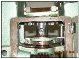
4.2.7. Colocar el punzón superior haciendo coincidir el orificio de la base de este, con el orificio sujetador en la parte superior del eje de la tableteadora. Colocar el tornillo sujetador, con la ayuda de una llave adecuada, hasta que
