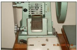
NOTA: LAS REJILLAS PROTECTORAS DE LOS PUNZONES SUPERIOR E INFERIOR, SE CERRARAN HASTA QUE LA MAQUNA SE CALIBRE CON EL PESO Y DUREZA DURANTE EL PROCESO DE FABRICACION.
