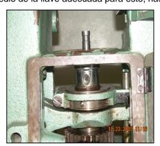
**4.2.3.** Girar manualmente la manivela de la derecha para hacer subir el punzón superior y verificar que este a nivel con la superficie donde se colocara la platina. De no ser así, aflojar el tornillo ubicado en la parte izquierda de la base y hacer girar la pieza circular horadada en la dirección adecuada (izquierda o derecha) para poner la pieza que sostiene el punzón a nivel.
