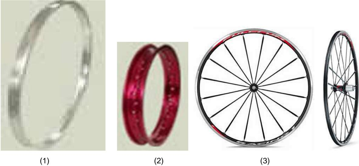
(1)Aro N° 26 de Montañesa de hierro, (2) Aro de Aluminio N° 20 BMX, (3) Aro Armado N° 700 x 23C de Semi carrera de Fibra de Carbón
