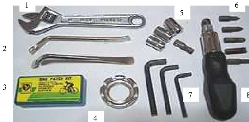
Herramientas básicas para reparación de una bicicleta. 1) Llave inglesa. 2) Palancas para desmontar. Cubiertas. 3) Estuche de parches para reparar cámaras. 4) Llave para radios. 5) Llaves de tubo de 8, 9 y 10 mm. 6) Puntas de destornillador planas y de estrella. 7) Llaves Allen de 4, 5 y 6 mm. 8) Destornillador de puntas intercambiables.<sup>6</sup>
