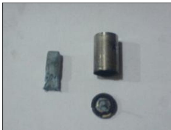
Figura 3. 1. Extracción de ánodo de pila alcalina.
