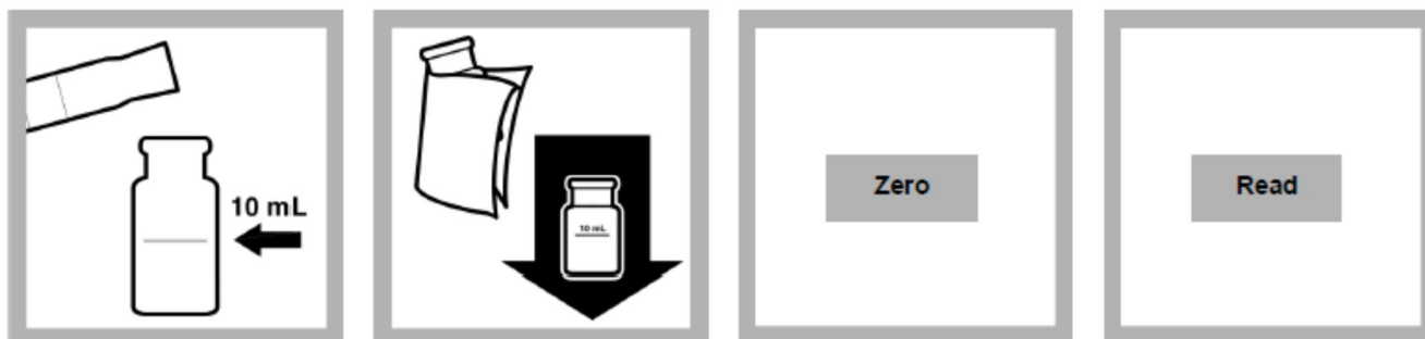
Ilustración 3. Lectura de absorbancia por método del Zincon.
