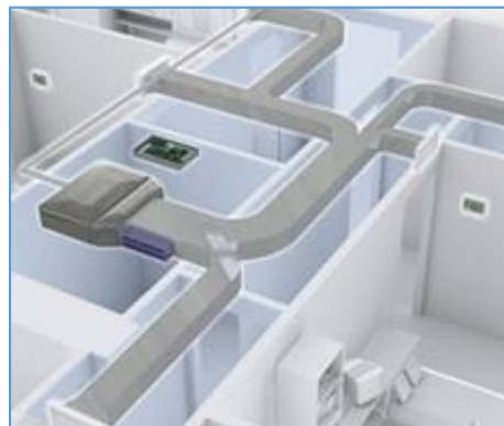
Figura 1.1-8. Unidad de AA con sistema de conductos [16].
