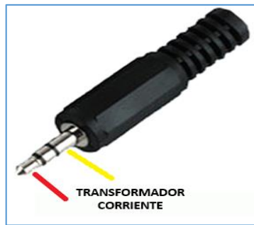
Figura 2.5-5. . Configuración de la espiga tipo plug 3.5mm de la pinza de corriente.
