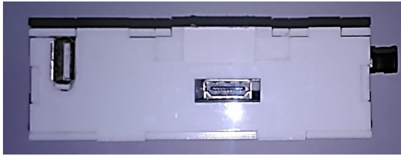
Figura 2.4-16. Parte inferior sub-sistema principal (puerto serial, HDMI).
