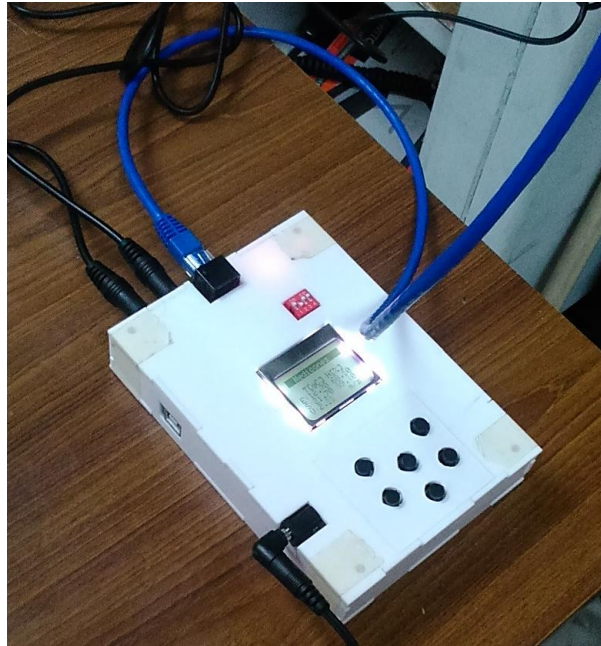
Figura 3.1-7. Sub-sistema 1 para mediciones de humedad, temperatura y velocidad flujo de viento.
