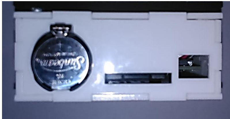
Figura 2.4-14. Parte lateral izquierda (batería RTC, tarjeta SD, Fuente).
