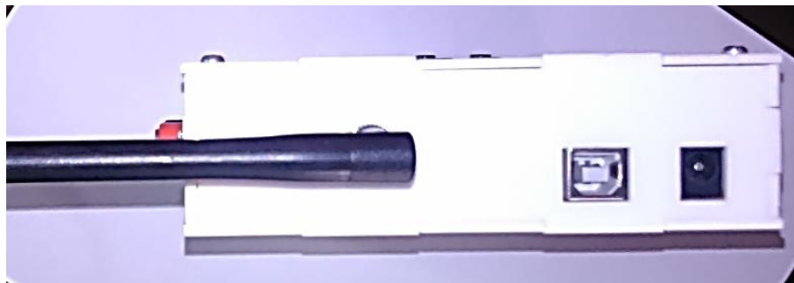
Figura 2.6-11. Parte lateral izquierda sub-sis.2 (antena, USB y fuente).
