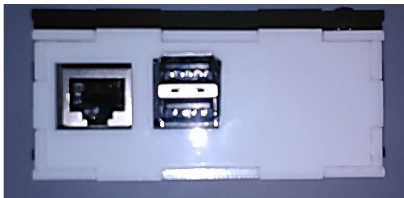
Figura 2.4-15. Parte lateral derecha (puertos USB y conector RJ45).
