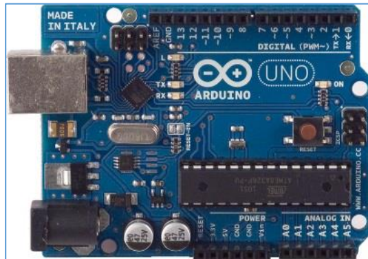
Figura 2.2-3. Arduino UNO rev 3 [4].
