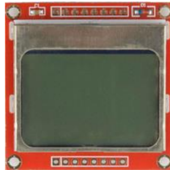
Figura 2.2-6. Pantalla LCD Nokia 5110/3310 con controlador PCD8544 [2].
