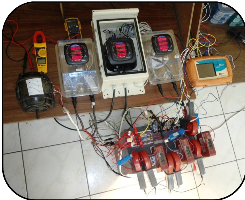
Figura 29 Prueba de medidor utilizando dos patrones de trabajo y uno de referencia.
