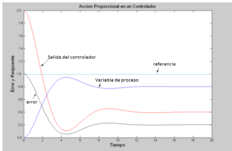
Figura 1. 5 Acción Proporcional en un Controlador [1.2]
