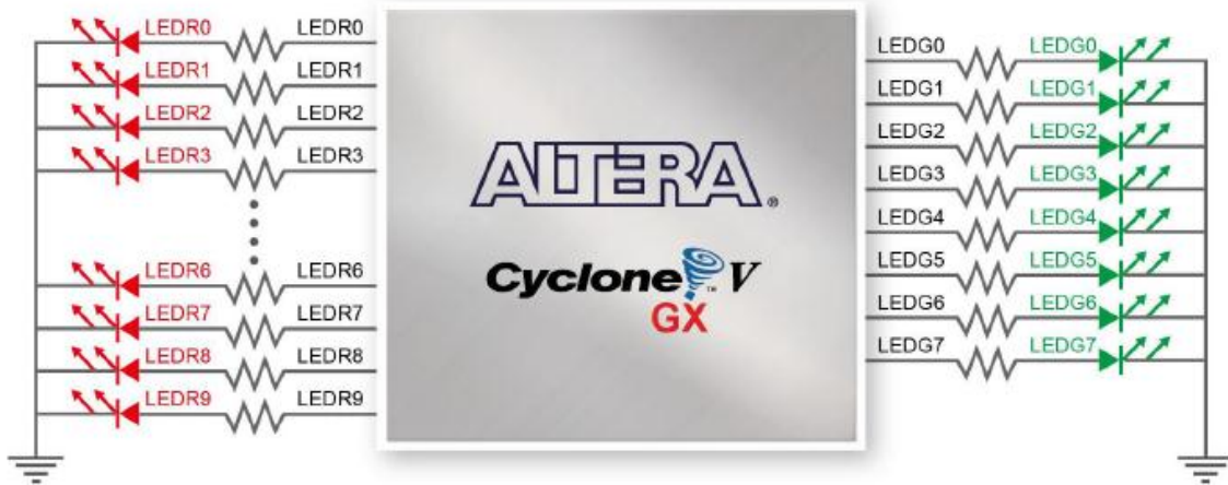
Figura 2.13. Conexión interna entre los led's disponibles para el usuario y el chip cyclone V GX. [2.1]
