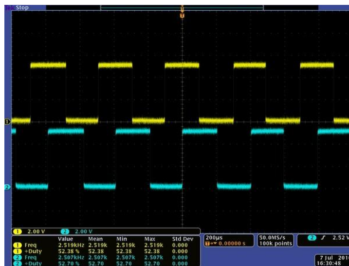
Figura 2.22.. Vista en el osciloscopio de la salida del encoder. [2.2]
