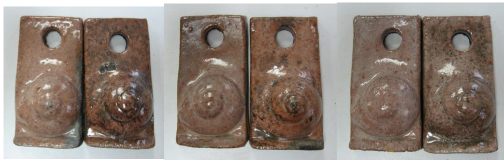
Figura 33; de izquierda a derecha, pruebas del cuadro 8 con 1%, 2% y 3% de opacificador, primera de cada pareja sometida a choque térmico en agua, segunda a proceso de reducción en aserrín
