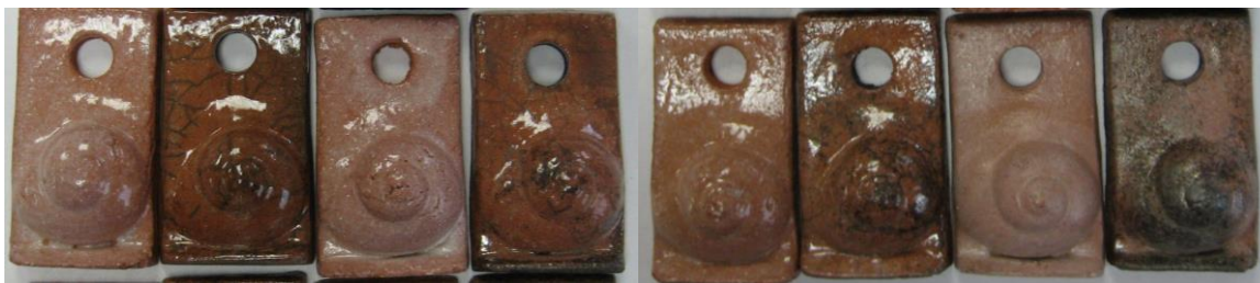
Figura 36; de izquierda a derecha, pruebas del cuadro 11 con 3% de opacificador, primera de cada pareja sometida a choque térmico en agua, segunda a proceso de reducción en aserrín
