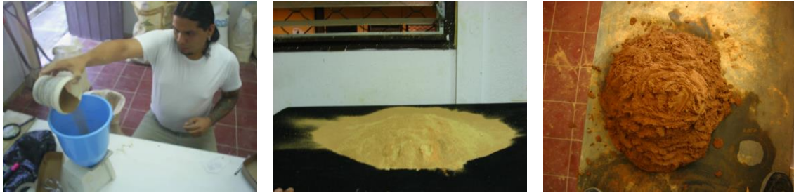
Figuras 55, 56, 57; De izquierda a derecha, proceso de pesado de materia prima en polvo; arcillas mezcladas en porcentajes establecidos; pasta preparada lista para amasado.
