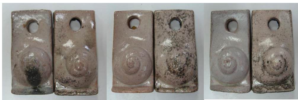
Figura 34; de izquierda a derecha, pruebas del cuadro 9 con 1%, 2% y 3% de opacificador, primera de cada pareja sometida a choque térmico en agua, segunda a proceso de reducción en aserrín
