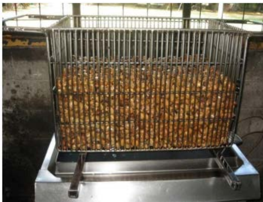
Figura 18: Cocina de acero inoxidable utilizada anteriormente por APRAINORES para la cocción de semilla de marañón. Fuente: Cortez 2009.
