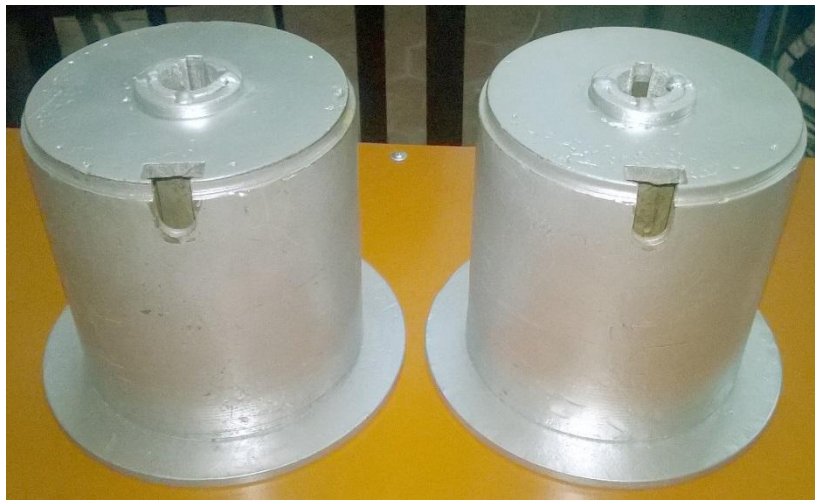
Fig.3.5. Tambores de trefilado maquinados, soldados y pintados.
