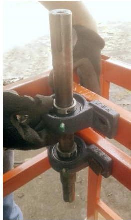
Fig.3.8. Montaje del eje y sus chumaceras.
