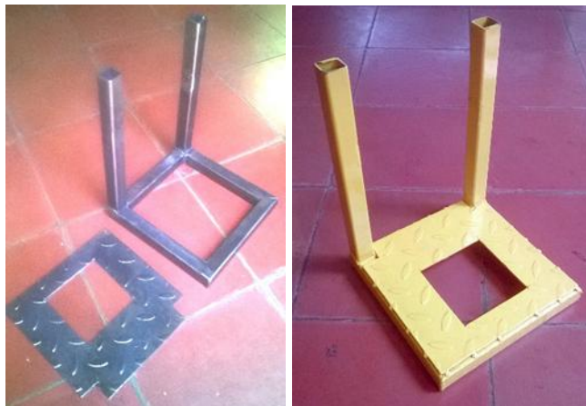
Fig.3.4. Piezas que conforman el soporte del motor y soporte finalizado.
