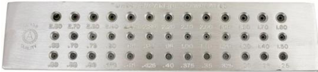
Fig.2.12. Hilera de acero con dado de tungsteno para joyería de caña redonda.
