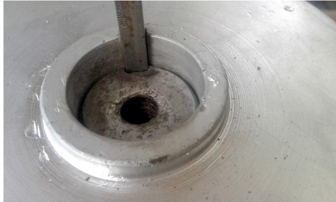
Fig.3.15. Instalación de tambor y cuña.
