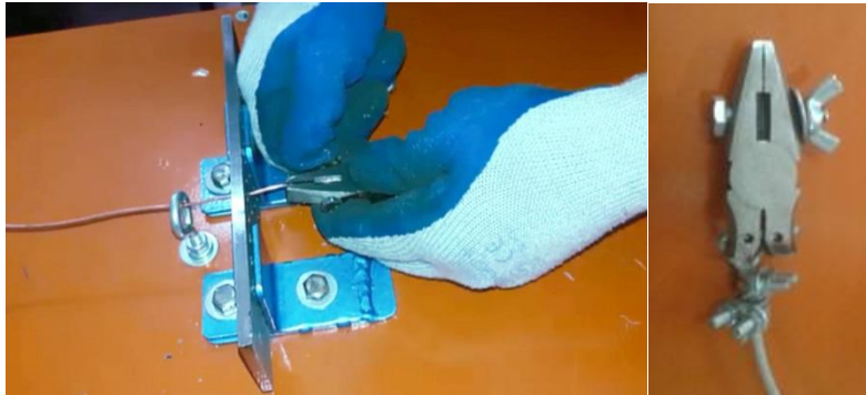
Fig. A.4. Sujeción de alambre mediante dispositivo de enganche.
