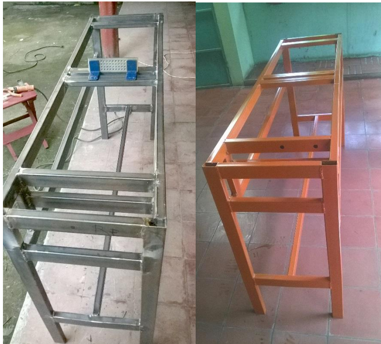
Fig.3.3. Limpieza de la estructura, bancada finalizada debidamente pintada.
