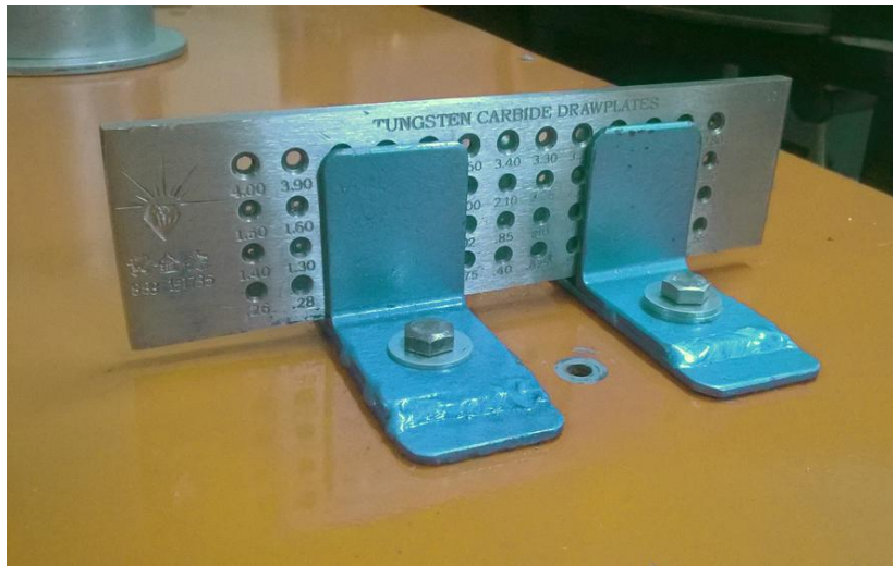
Fig. 3.6. Soportes de hilera finalizados, forma de uso de estas.
