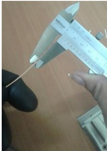
Fig. A.6. Medición del diámetro del alambre.
