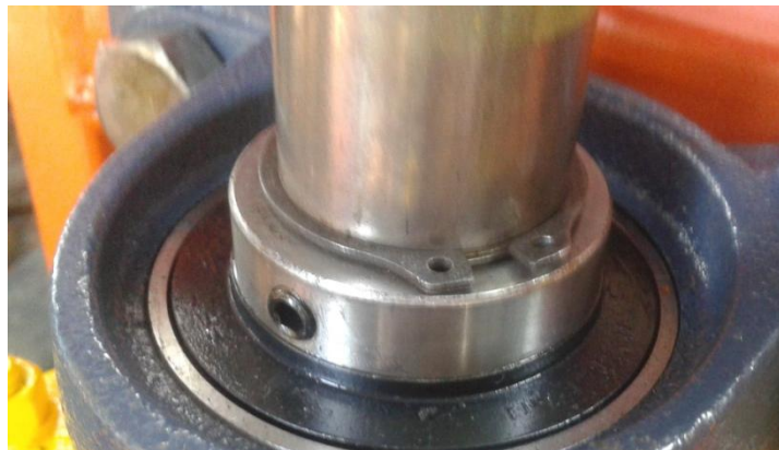
Fig.3.9. Sujeciones del eje de transmisión.
