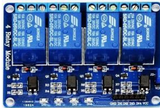
Ilustración 24: Módulo de relevadores
