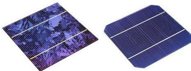
Ilustración 7: Celdas Fotovoltaica Policristalina y Monocristalinas respectivamente
