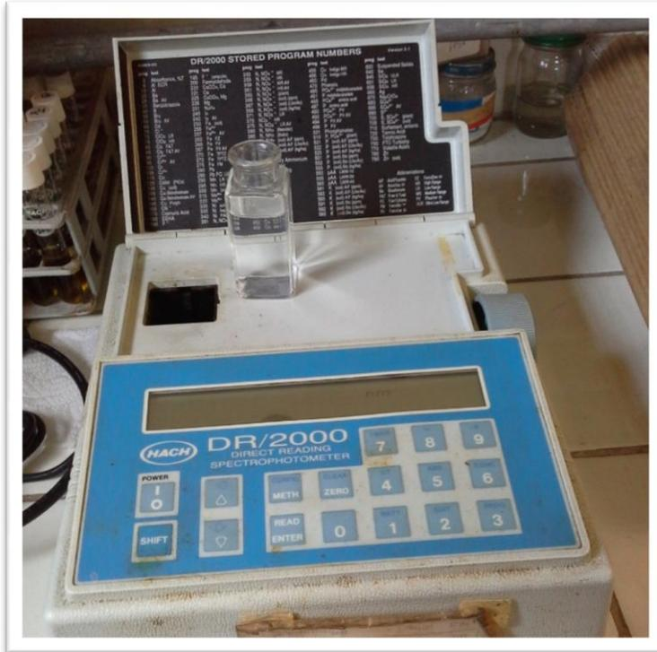
**A.5. Equipo utilizado para la determinación de Fosfatos y Cromo Hexavalente.**
