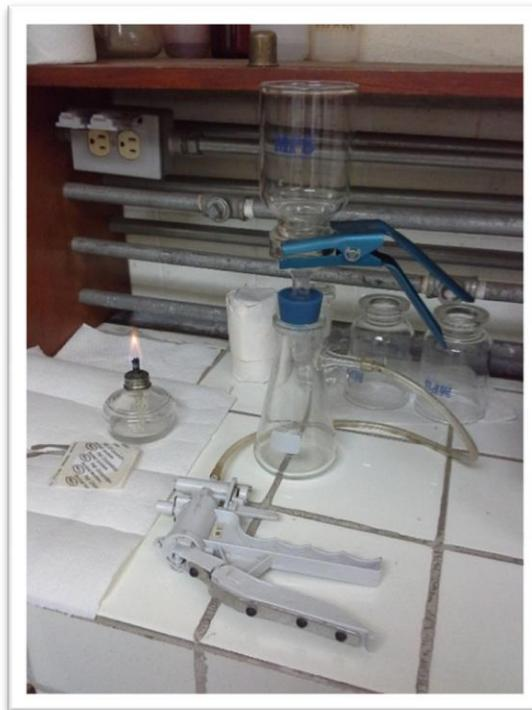
**A.8. Equipo utilizado para la determinación de los Coliformes Fecales.**
