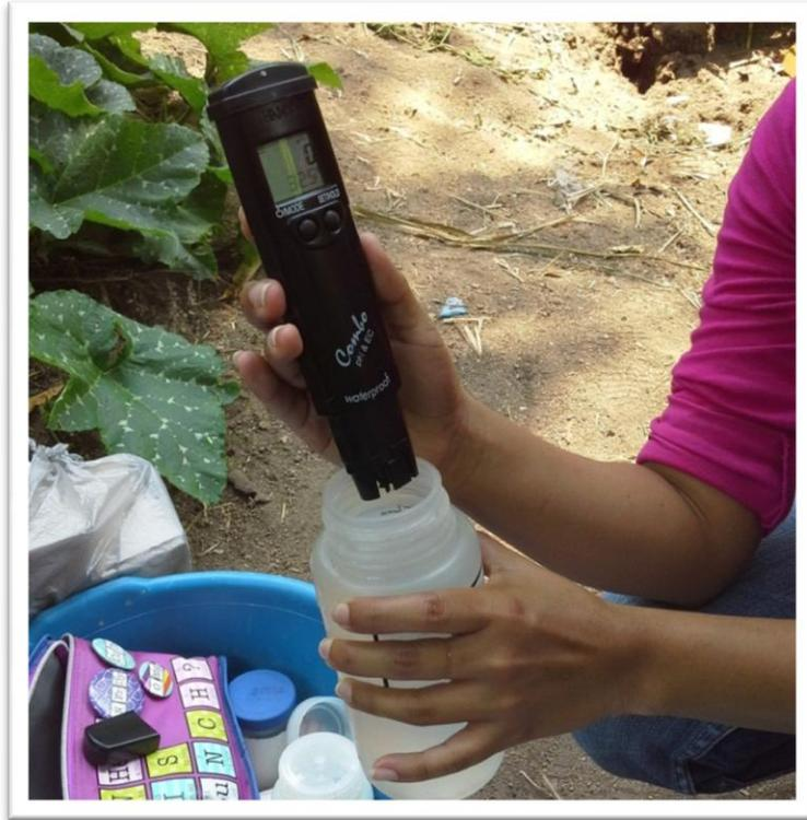
**A.3. Equipo medidor de pH, EC/TDS y temperatura HI 98129.**
