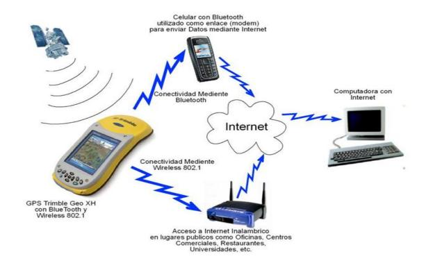
En donde se muestra un GPS Trimble Geo XH conectado mediante tecnología LAN inalámbrica y otra con Blue Toth a un enlace de Internet, donde se usa el cliente pocket Outlook para enviar los datos recolectados como archivos adjuntos, a una dirección de correo electrónico que se accesará en la oficina para procesar los datos mediante "Trinble Pathfinder office".
