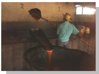
Figura N° 10: Extracción de los peroles de cocimiento
