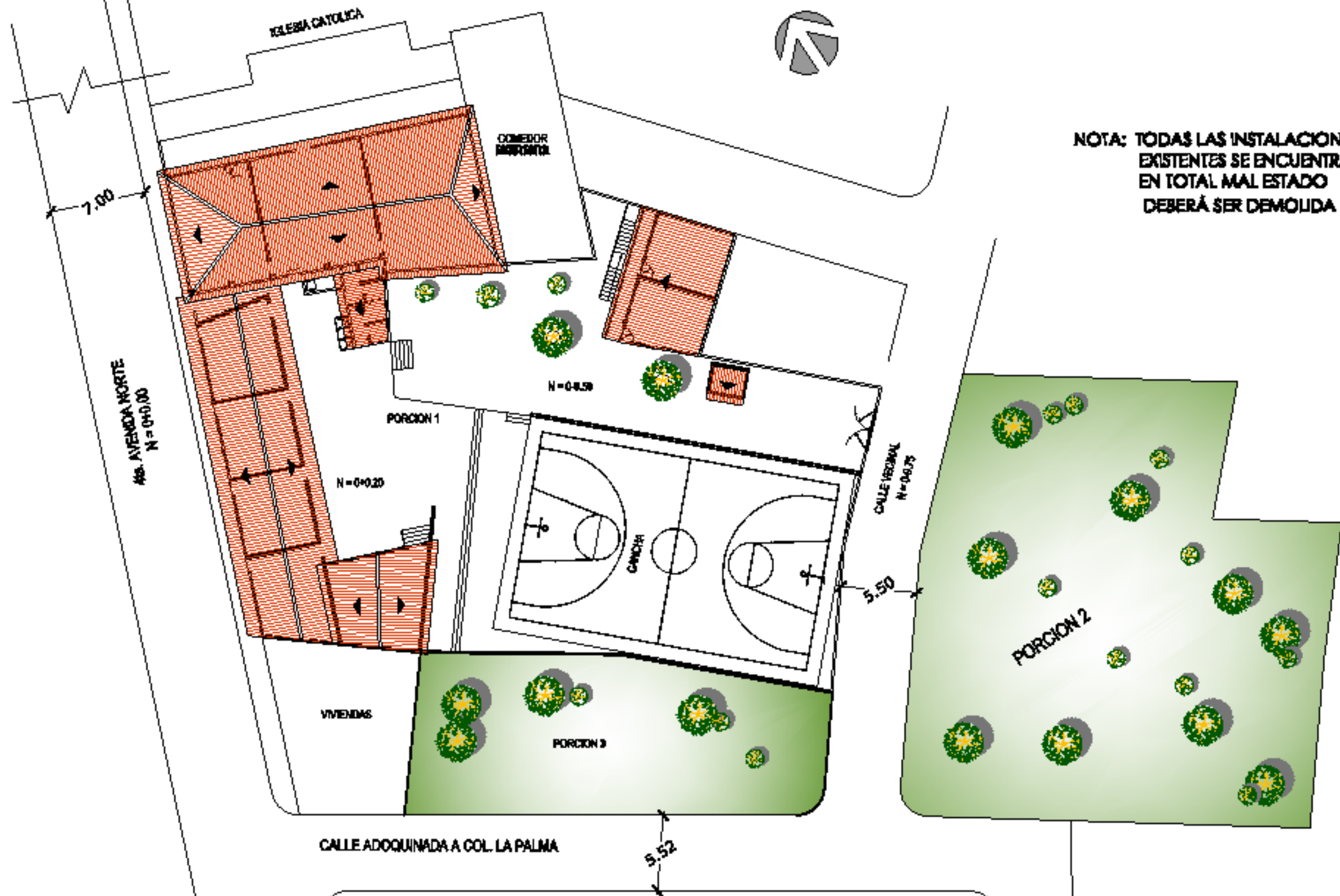
PLANTA DE CONJUNTO Y TECHOS INSTALACIONES EXISTENTES ESCALA 1:500
