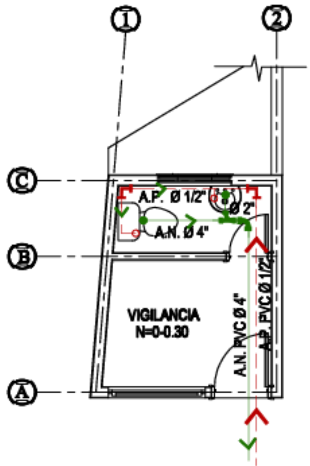
PLANTA DE INSTALACIONES HIDRAULICAS VIGILANCIA PARVULARIA ESCALA 1:50
