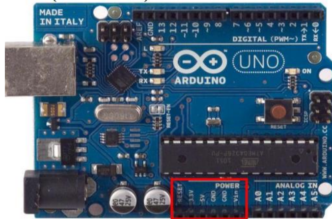
Figura 30. Pines de alimentación Placa Arduino.
