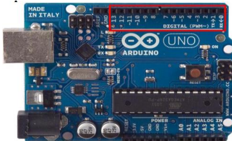
Figura 31. Pines digitales entradas/salidas placa Arduino.
