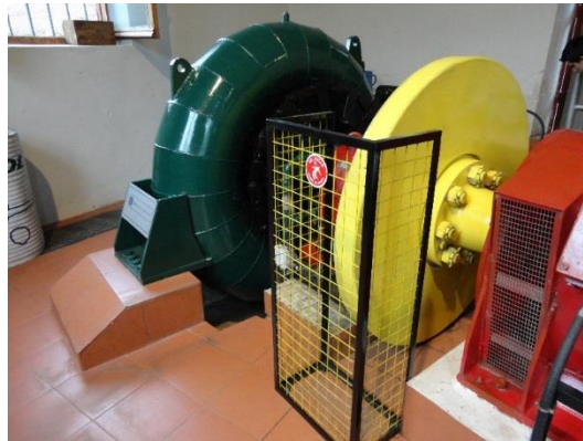
Figura 8. Volante de inercia en una máquina hidráulica.
