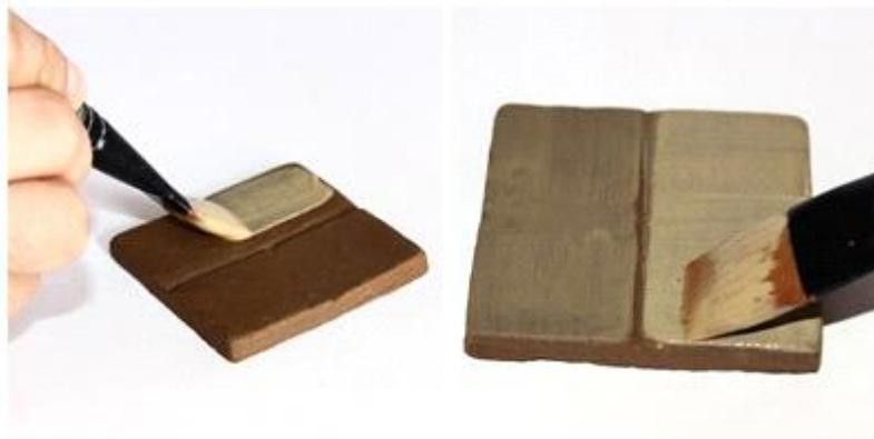
*Imagen 8. Aplicación de engobe combinado por pincel sobre teja de ensayo. Equipo de Investigación.*
