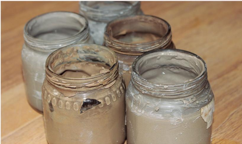
Terminado el engobe y listo para utilizarse, se recomienda ser guardado en frascos de vidrio o plásticos limpios, de manera que se pueda conservar libre de cualquier contaminación y/o entradas de aire.
