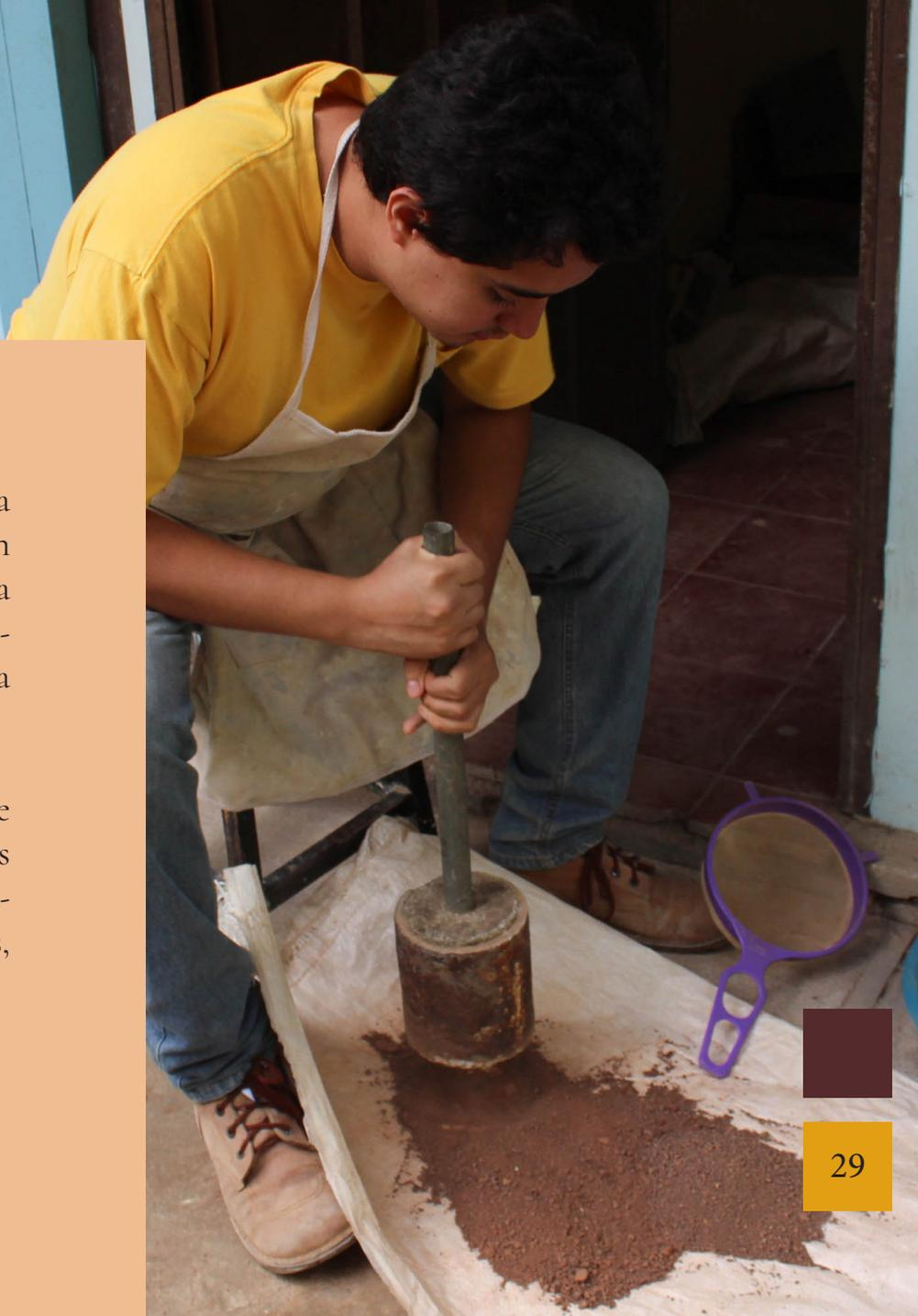
Se utiliza malla N°110 para el colado, permitiendo únicamente el paso de partículas finas de barro, garantizando que el engobe posea un acabado refinado.
