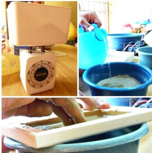
*Imagen 7. Procedimientos para elaboración de muestras de engobes, Peso, hidratación y colado de los materiales. Foto por equipo de investigación.*
