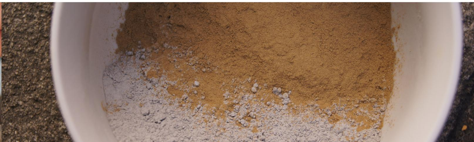
Se realiza la mezcla en seco en un recipiente totalmente libre de humedad, haciéndose con una cuchara o directamente con las manos hasta lograr la homogenización de ambas partes.
