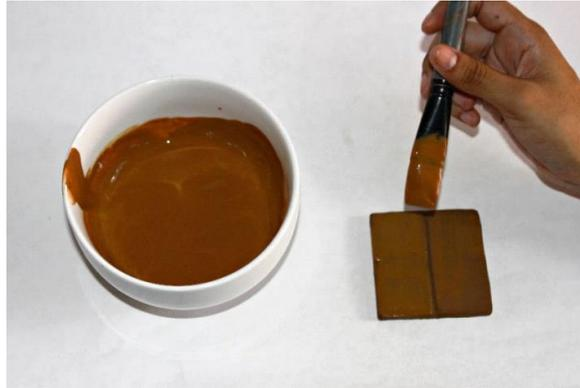
*Imagen 8. Proceso de Aplicación de engobe C.R. sobre Teja de Ensayo, Foto por equipo de Investigación.*
