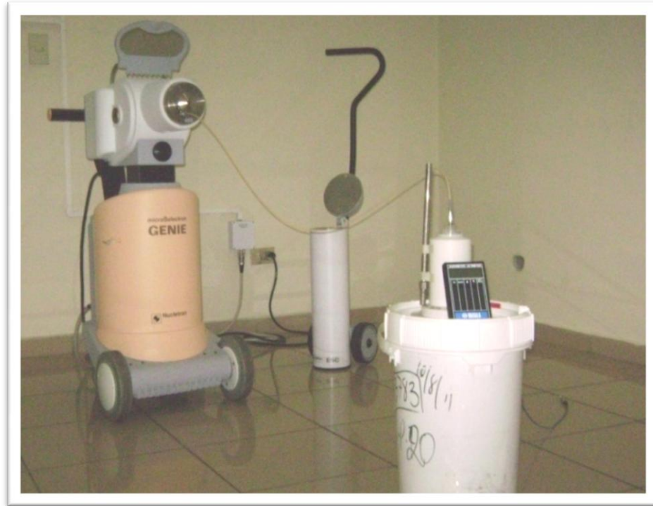
Figura 16. El Primer montaje el día de la calibración. Muestra la forma en que se colocó la cámara de pozo respecto a la fuente radiactiva con una distancia de 1m, se observa además el termómetro colocado adherido a la cámara y cerca de ellos el barómetro.
