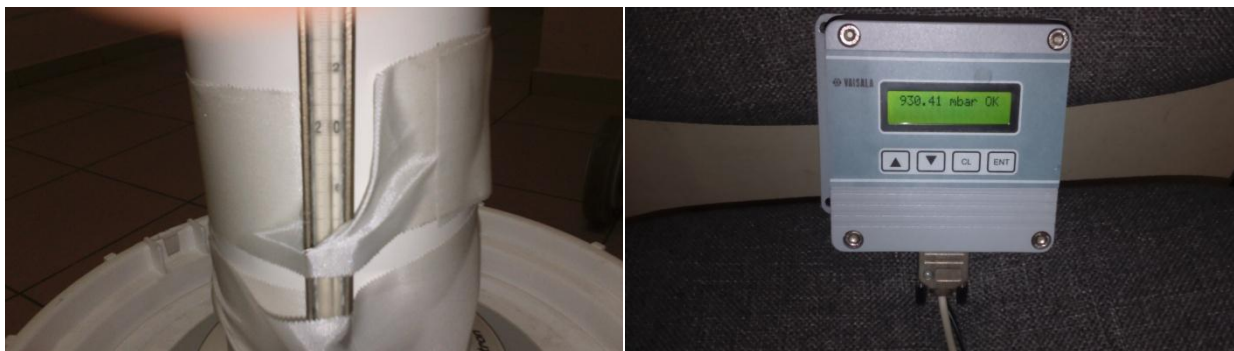
Figura 22. Termómetro y barómetro respectivamente en donde medimos la temperatura y presión atmosférica a la hora de adquirir los datos en cada una de las calibraciones. Fotografía tomada el día de la calibración.
