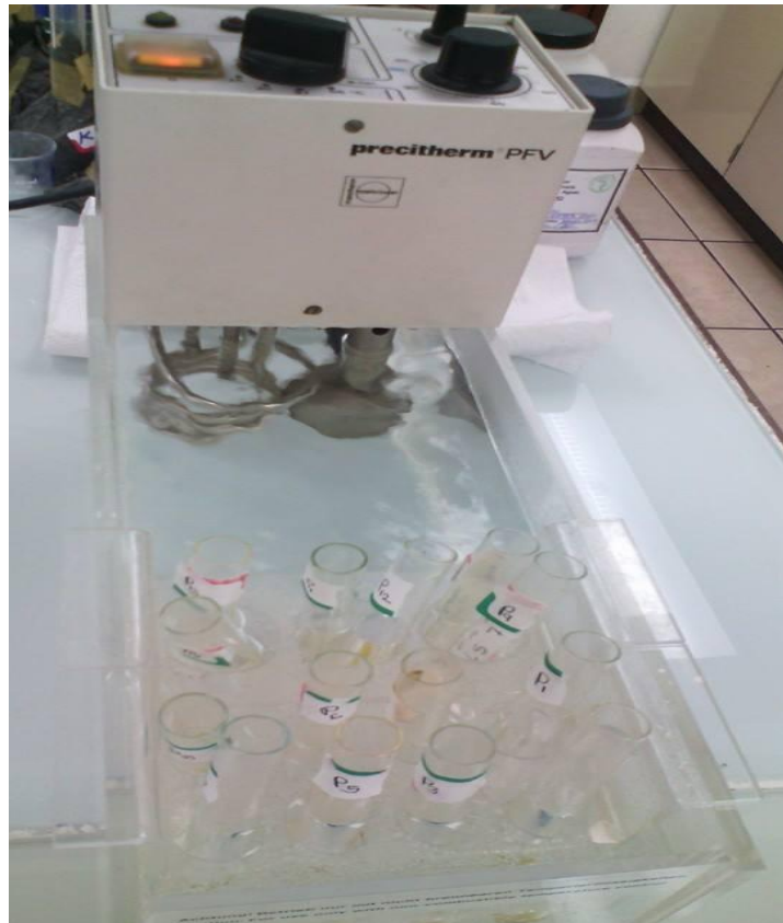
Fig. 33. Baño de María, Precitherm PFV, utilizado para fundir las muestras y mantenerlas a una temperatura de 60 \pm 2 \text{ }^\circ\text{C}
