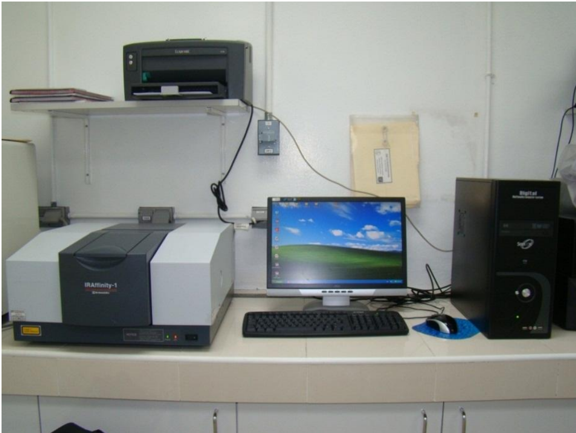
Fig. 28. Aparato de Espectrofotetría Infrarroja de transformada de Fourier, con el ordenador que contiene el programa IR-RESOLUTION, en el laboratorio Físicoquímico de Aguas
