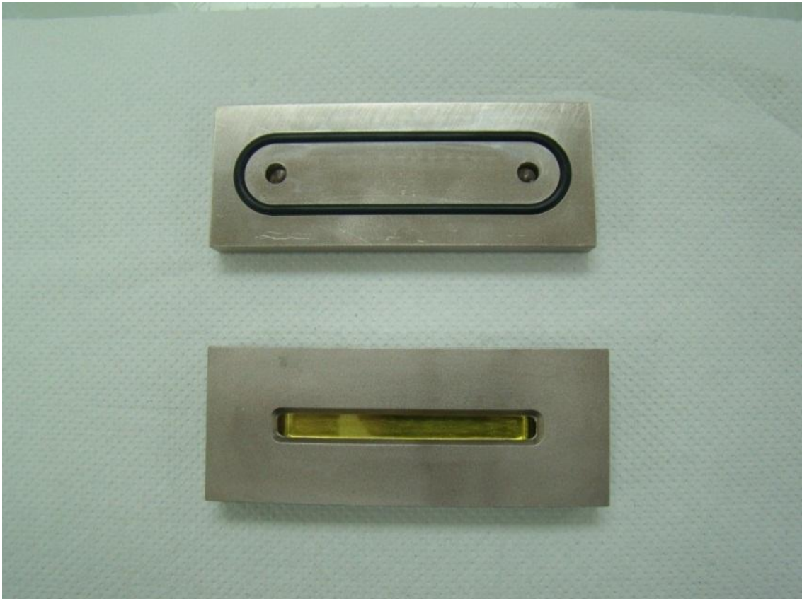
Fig. 31. Celda de Reflectancia Total Atenuada en la que se realizaron los análisis del aceite extraído de muestras de Platanitos, Yuquitas, Estrellas, Churros Españoles, y Papas fritas.
