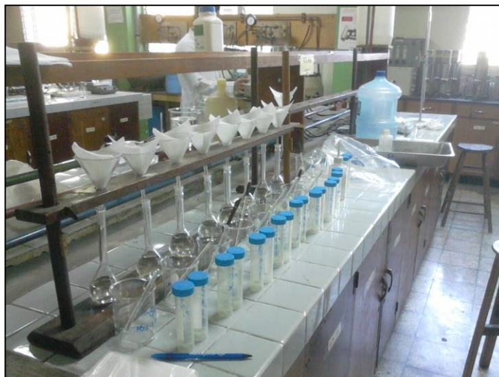
Figura 4. Preparación y digestión de muestras de aguas para determinación de minerales de interés nutricional y metales pesados.
