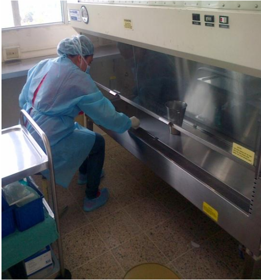
Figura N° 8. Cabina de flujo laminar vertical Clase II tipo B
