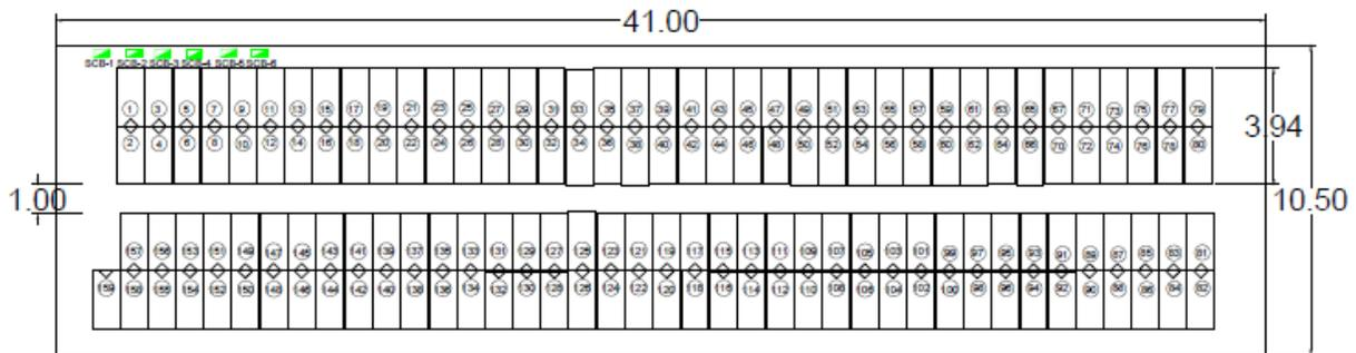
Figura 27: Distribución de los módulos fotovoltaicos en el techo del edificio de administración académica (todos los valores en metros).
