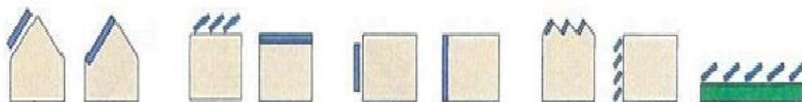
Figura 15: Formas de instalar los MFV. Sobre techos inclinados, integrado al techo, en techos planos, en la fachada, como tragaluz, como cubre sol, en el piso, en la FIA se instalaran sobre techo inclinado y losa <sup>5</sup>.
