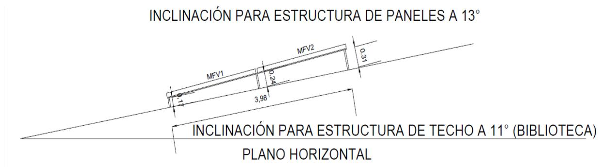
Figura 33: vista de perfil de estructura de soporte para MFV.
