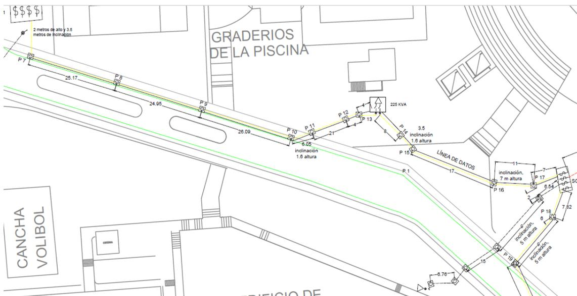
Figura 42: Primer tramo troncal con cable #4/0 a 23KV.
