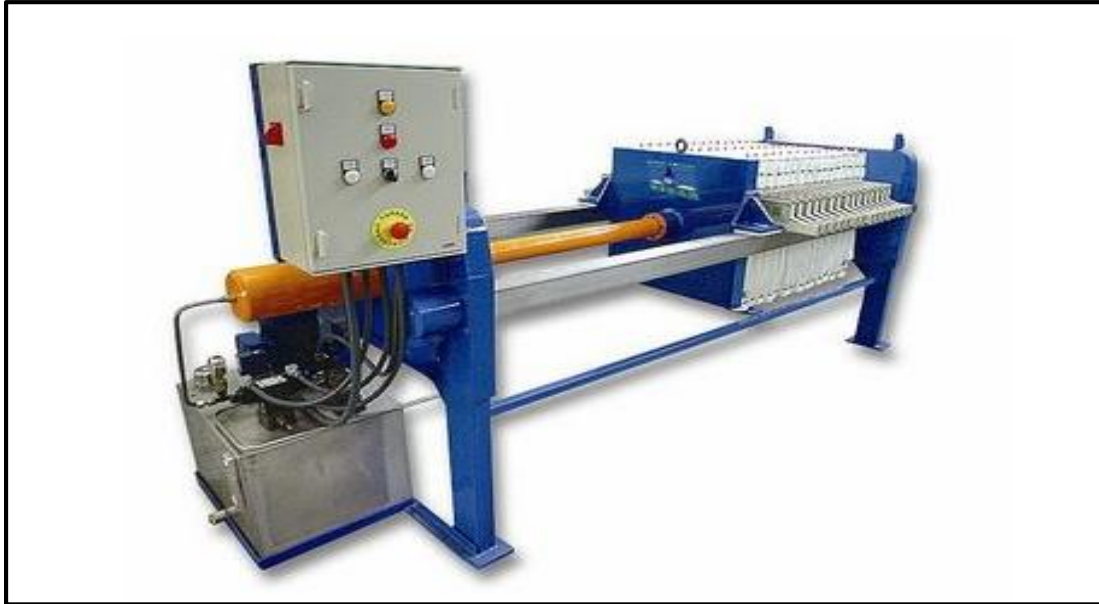
Figura 3. 8 filtro prensa. Fuente: GEDAR, tratamiento de aguas residuales.
