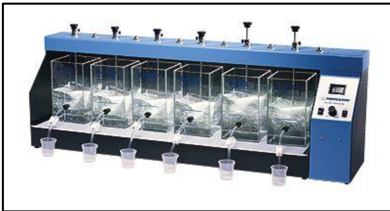
Figura 3. 6 Equipo para realizar la prueba de jarras. Fuente: www.r-chemical.com
