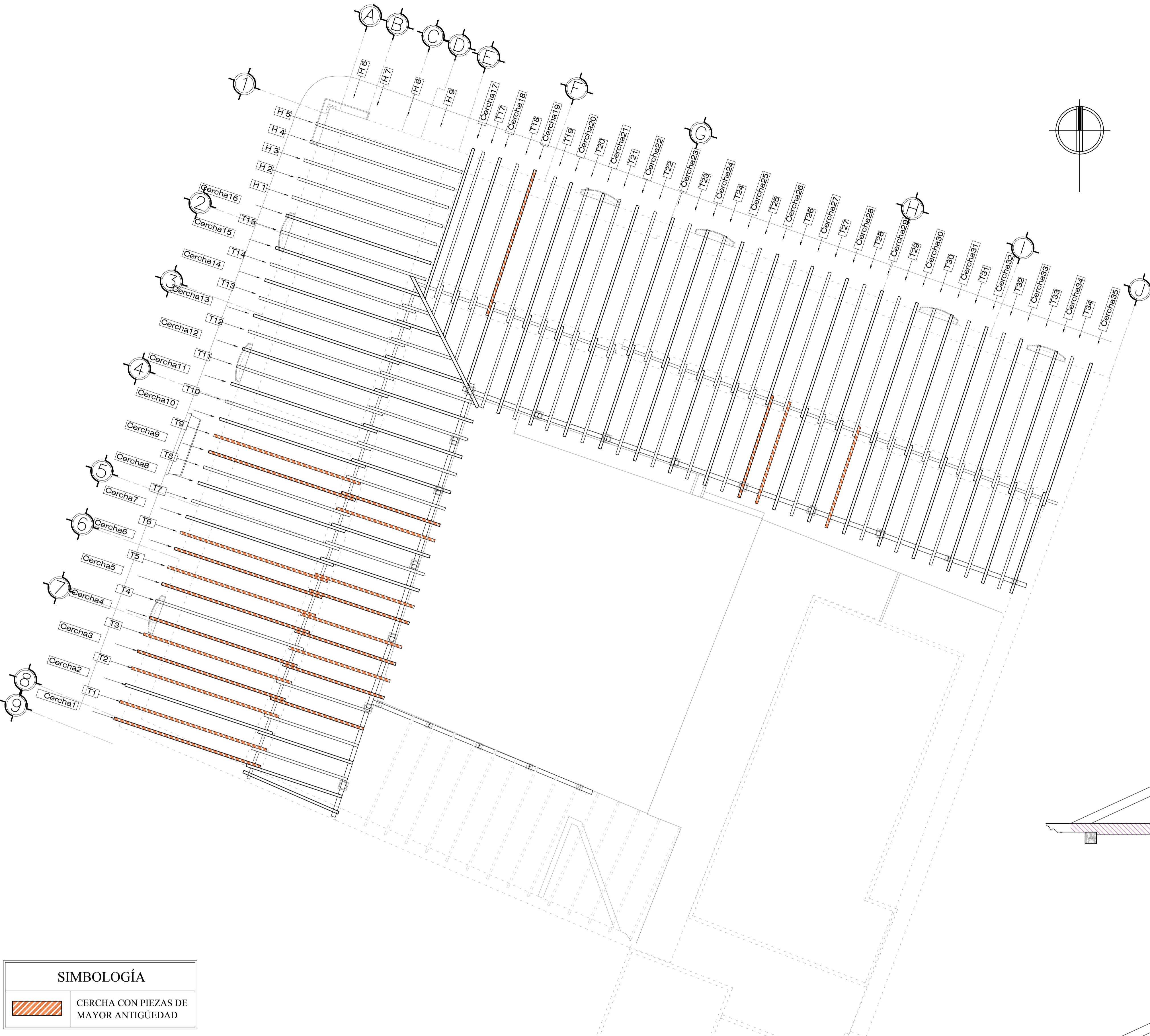
PLANO DE IDENTIFICACION DE DAÑOS EN ESTRUCTURA DE TECHOS VIGAS Y TENSORES
