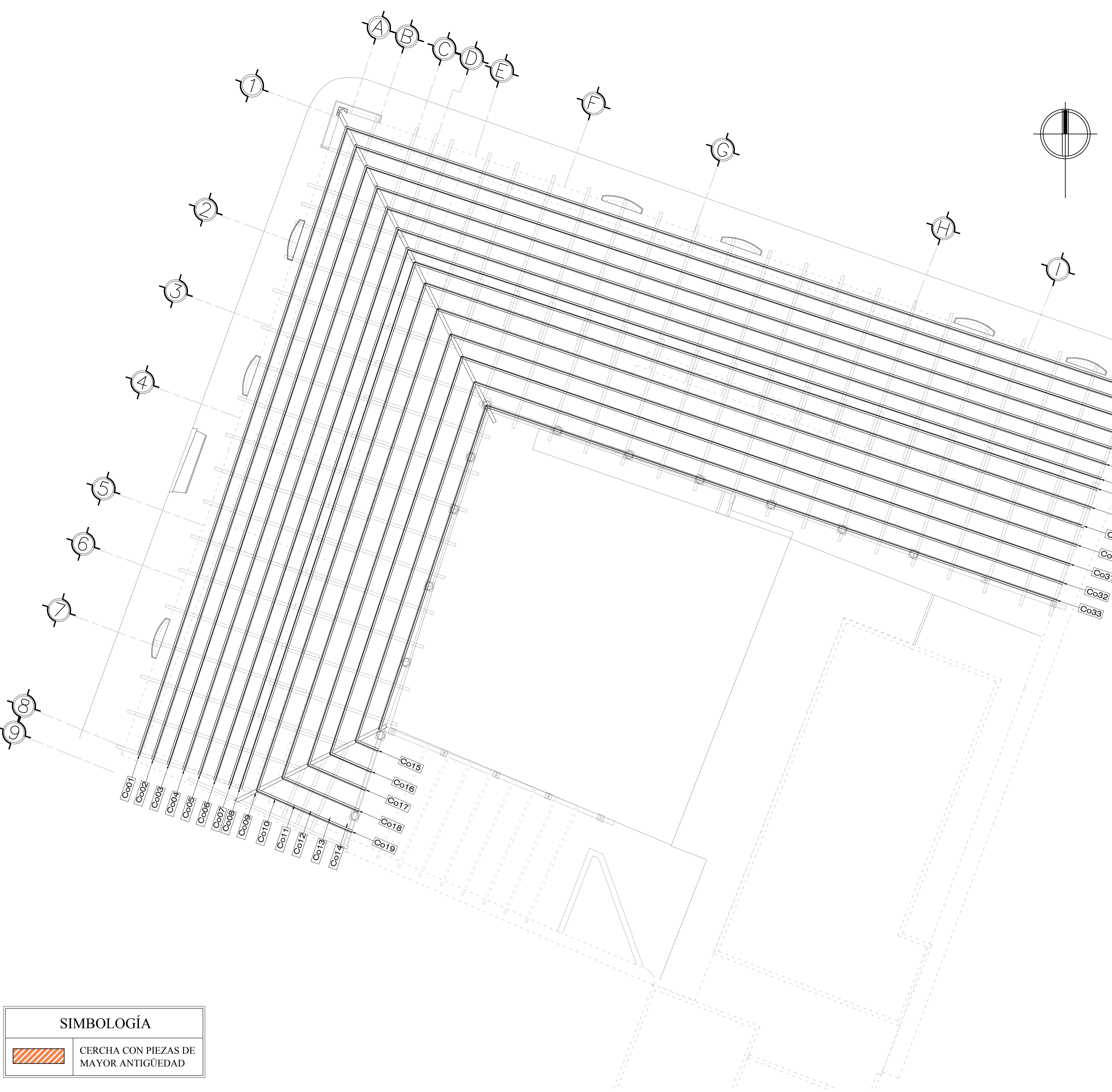
PLANO DE IDENTIFICACION DE DAÑOS EN ESTRUCTURA DE TECHOS CORREAS
