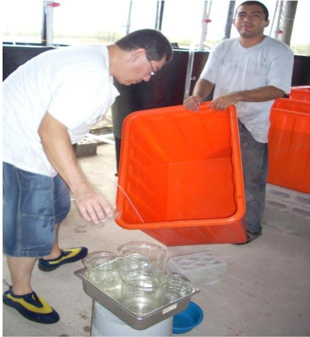
**Figura A17.** El conteo volumétrico se realizó extrayendo cinco muestras de 1 litro cada una con ayuda de un matraz Beaker.
