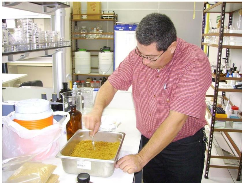
**Figura A28.** Remover el concentrado con una varilla de vidrio para homogenizar la solución.
