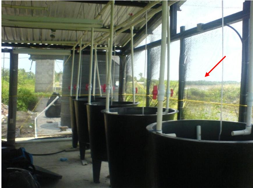
**Figura A13.** Distribución de aire mediante mangueras translucidas, en tanques de 300L.
