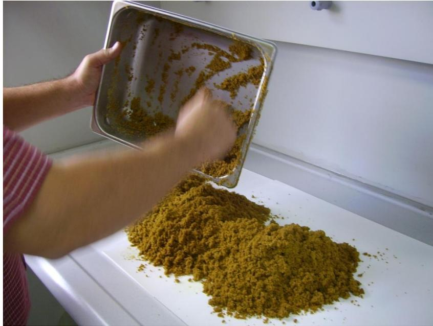
**Figura A29.** El concentrado se vierte sobre la campana de extracción, extendiéndola sobre la superficie hasta alcanzar una capa menor de un centímetro.
