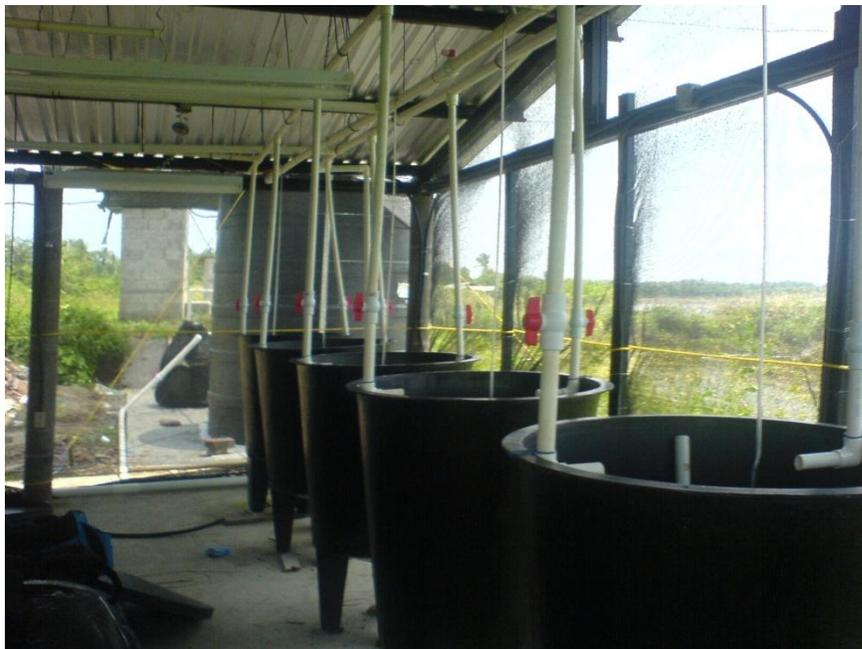
**Figura A18.** Estanques de tratamientos, seis tanques cilindro-cónicos de fibra de vidrio, con capacidad de 300 L color negro.
