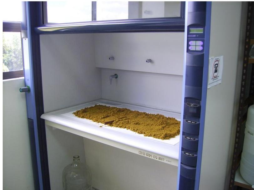
**Figura A30.** Trascorrido 30 minutos de evaporación se apaga la campana de extracción.
