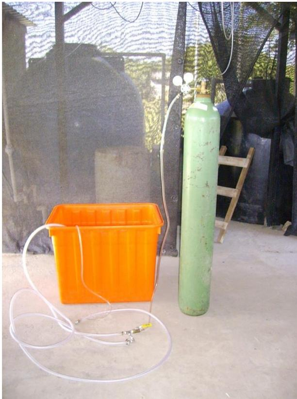
**Figura A16.** Sistema de aireación compuesto por un tanque cilíndrico de oxígeno, válvulas, mangueras y manómetro.
