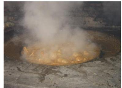
El "Punto" de panela se obtiene dependiendo del tipo de producto que se desea: para panela tradicional es de 122° C, y 128 °C para panela granulada.
