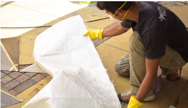
Mauricio Morales cubriendo una figura geométrica con fibra de vidrio para la posterior aplicación de resina.
