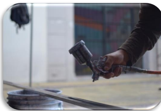
Elmer Ponce en el recubrimiento con esmalte automotriz a los tubos de hierro Fuente: Mauricio Morales Imagen N° 88
