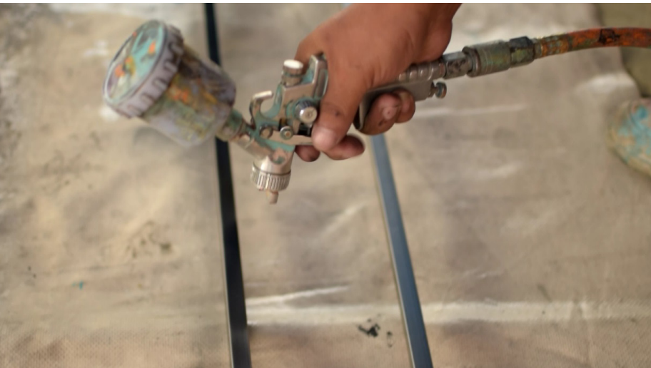
Aplicación de esmalte automotriz al tubo de ½ pulgada.
