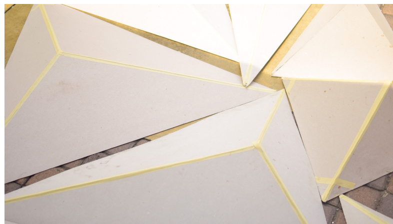
Figuras de cartón elaboradas como base para aplicar resina y fibra de vidrio
