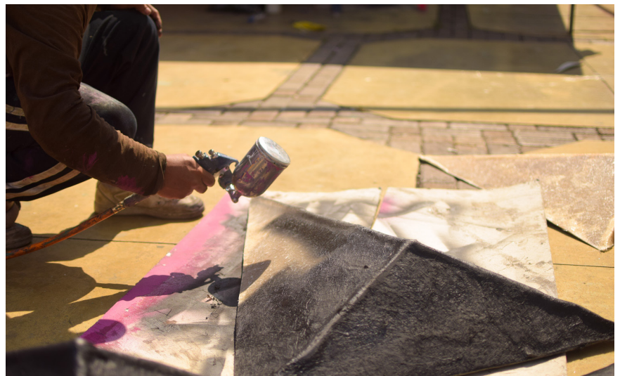
Elmer Ponce Aplicando pintura automotriz base a las piezas de resina.
