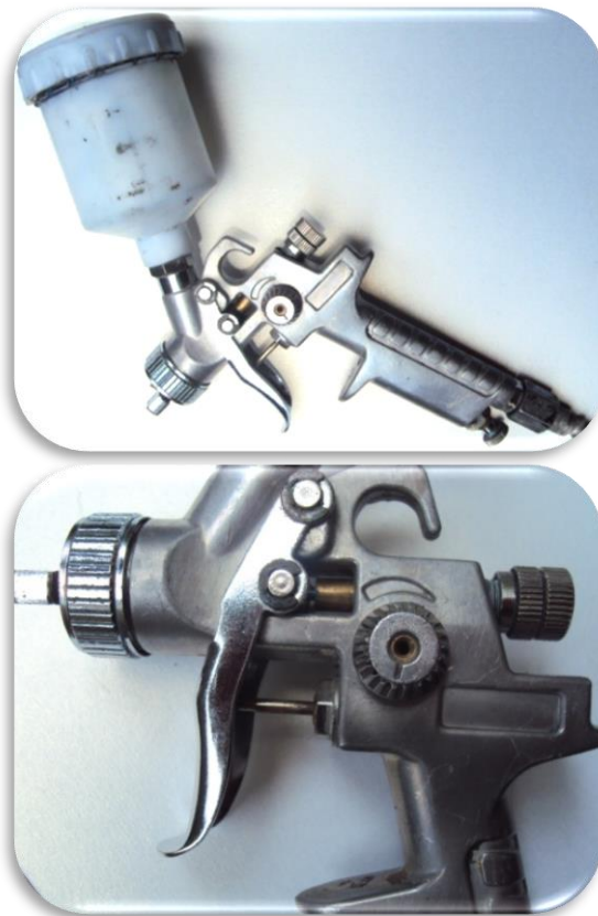
Pistola aerográfica para retoques Fuente: Elmer Ponce Imagen N° 75, 76
