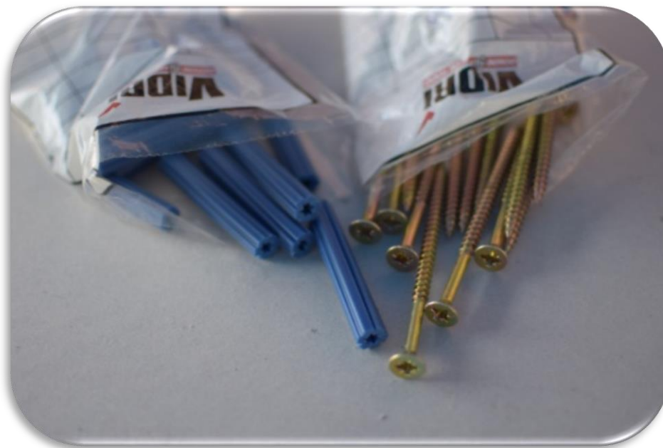
Anclas de 3" Pulgadas y tornillos de 3" ½ pulgadas Fuente: Mauricio Morales Imagen N° 89
