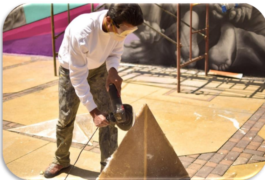
Mauricio Morales puliendo las orillas las figuras de fibra de vidrio Fuente: Raymond Barrera Imagen N° 100
