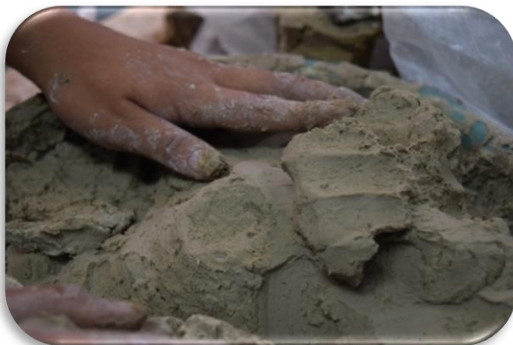
Bentonita en estado plástico.
