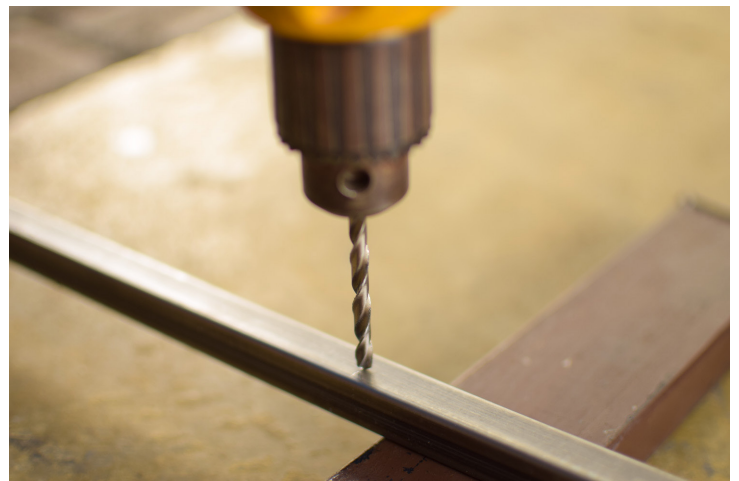
Posición correcta del taladro para perforar el tubo.
