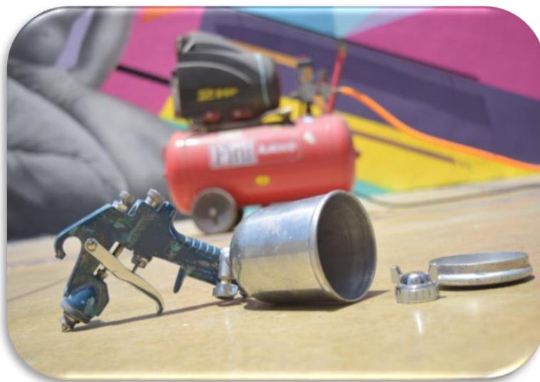
Compresor y pistola de gravedad utilizada para la aplicación del barniz protector
