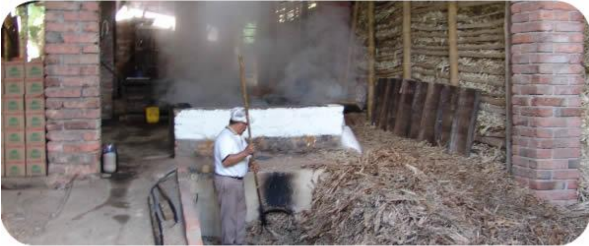
Alimentación del horno con el desecho de la caña (bagazo).
