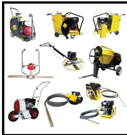
Imagen 3.8: Herramientas empleadas en la producción y fabricación de concreto en obra (Fuente: http://www.ecomec.org/equipos-de-construccion-liviana ).
