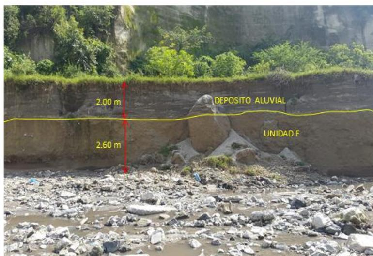
**Figura No. 2.10 Erosión lateral de unidad F en talud ubicado contiguo a ribera de ríos.**
