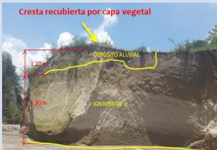
**Figura No. 4.27 Estratigrafía del Talud Cipreses II**
