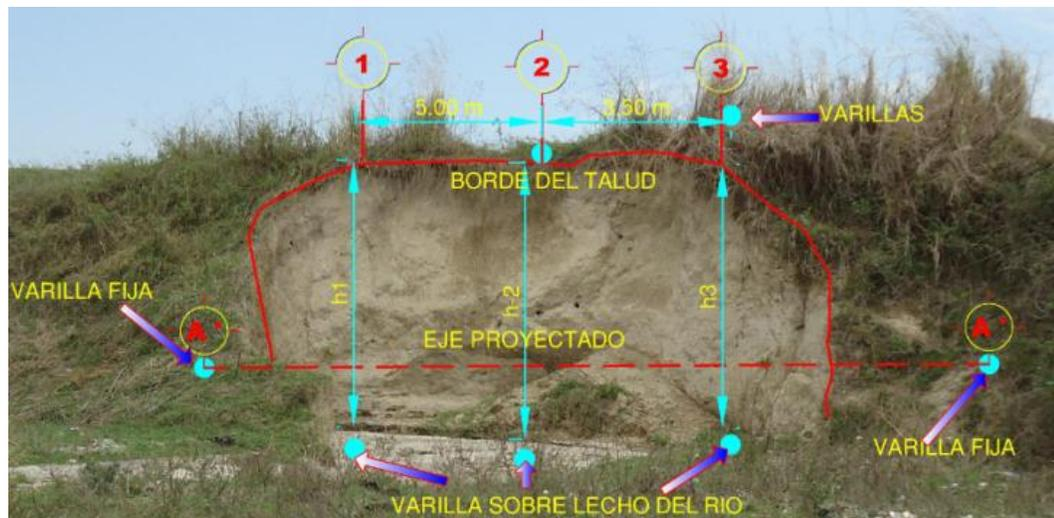
**Figura No. 4.72 Colocación de equipo de monitoreo en talud Galicia**
