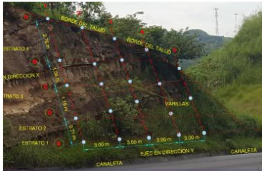
**Figura No. 4.62 Colocación de equipo de monitoreo en talud Arrupe II**
