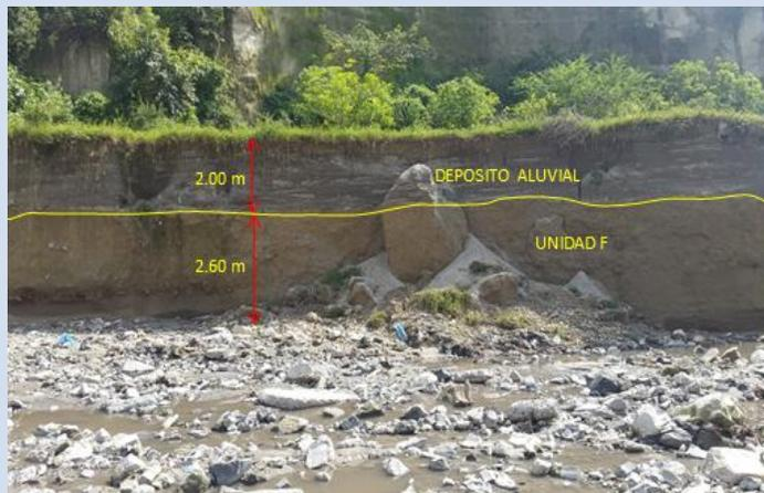
**Figura No. 4.31 Estratigrafía del Talud ZF-I**
