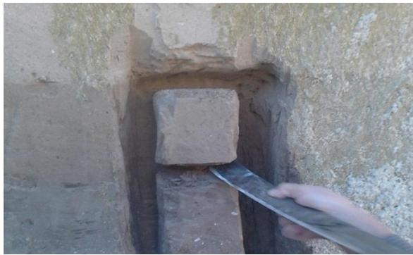
**Figura No. 3.9 Extracción de muestra inalterada**
