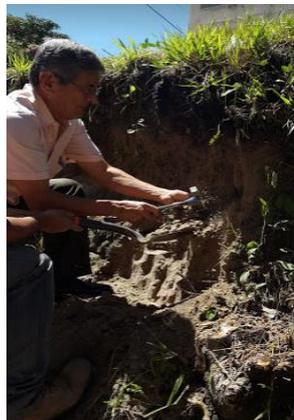
**Figura No. 3.8 Extracción de muestra alterada**
