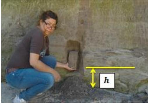
**Figura No. 3.10 Registro de altura a la que se extrajeron muestras inalteradas.**
