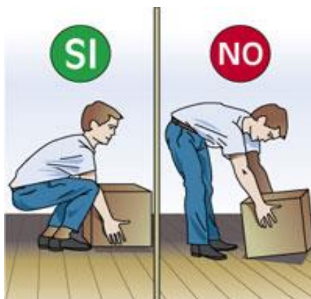
Figura 2.5 Forma correcta e incorrecta de levantar objetos pequeños pesados a mediana altura.
