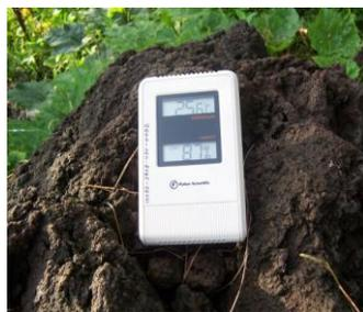
Figura 5: Termohidrometro, instrumento utilizado para medir factores climáticos
